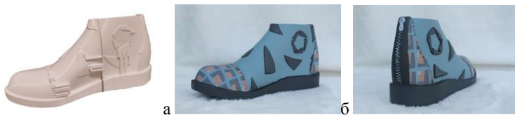
Рисунок 4 – 3D-модель: а) напечатанная необработанная 3D-модель; б,в) готовая 3D-модель в цвете.
