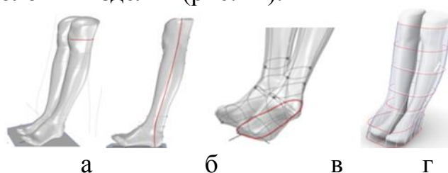
Рисунок 2 – Иллюстрация этапов проектирования: а, б, в) некоторые размерные признаки ног клиента; г) параметрическая поверхность изделия
