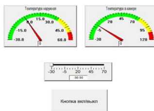
Рисунок 4 – Человеко-машинный интерфейс автоматической камеры тепла и холода
